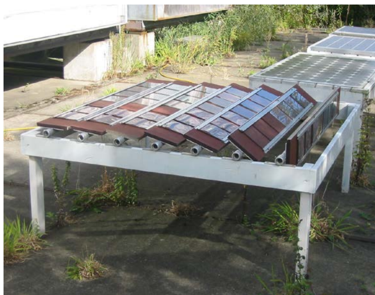
Foto 4.1: Proefopstelling van de buitenexpositie van de samples en modules.
